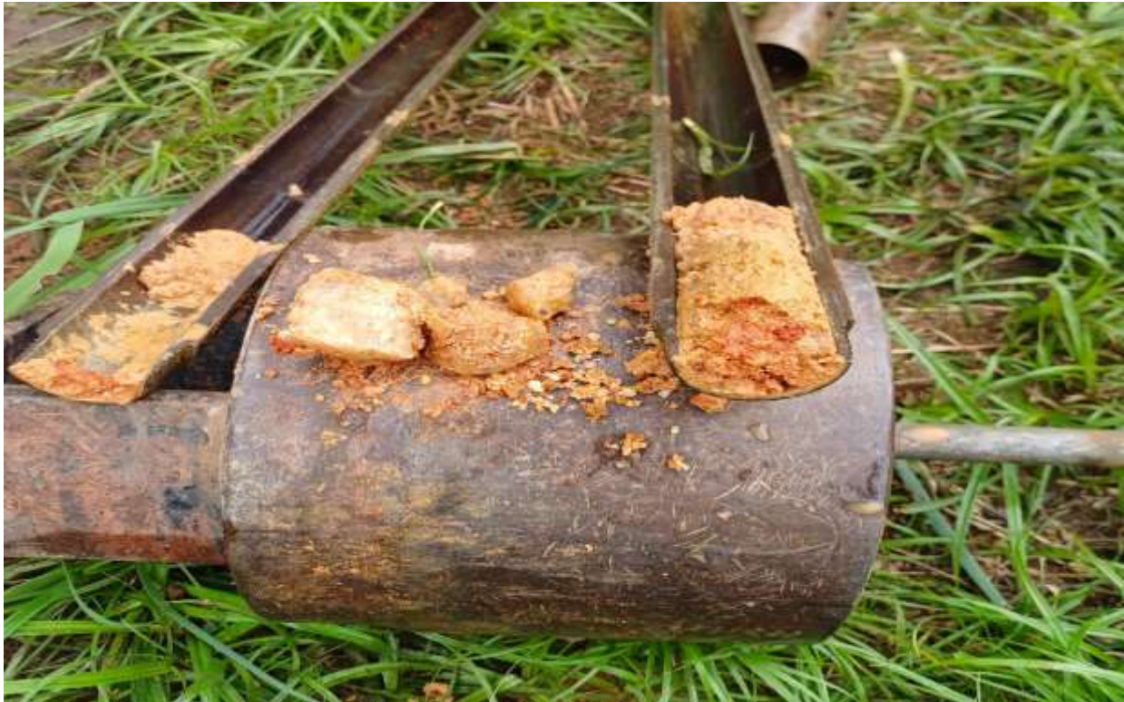
Figura 3: Amostra de solo com presença pedregulhos fino argila arenosa cor variegado compacto.
